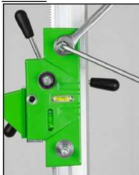
• Solte a contraporca no parafuso Allen usando uma chave de boca SW17 . • Ajuste os parafusos Allen e a posição da peça de encosto na coluna usando uma chave sextavada. • Aperte a contraporca novamente e verifique se o carro se move facilmente na coluna.
